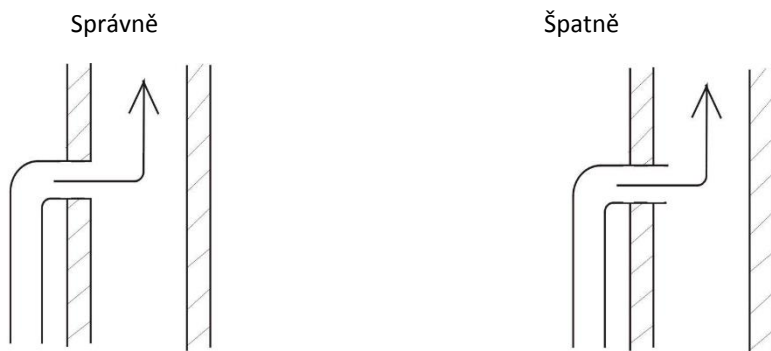
Obrázek 16 – Napojení kouřovodu do sopouchu
